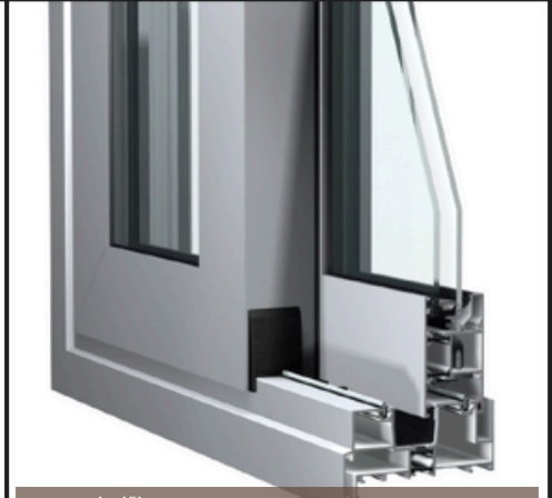
KASA DERİNLİĞİ: 125 MM - 1 RAYLI VE 2 RAYLI, 169 MM - 3 RAYLI İSİ YALITIMLI ALÜMİNYUM SÜRME DOĞRAMA SİSTEMİ
